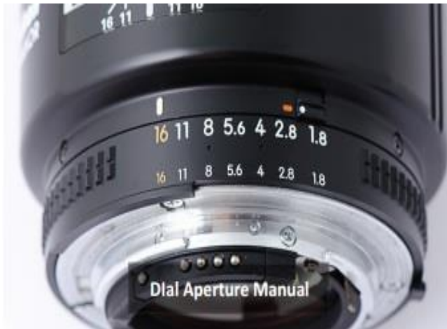
Gambar 1.17 Letak Ukuran Diafragma/Aperture pada lensa Sumber: https://www.digitografi.com
