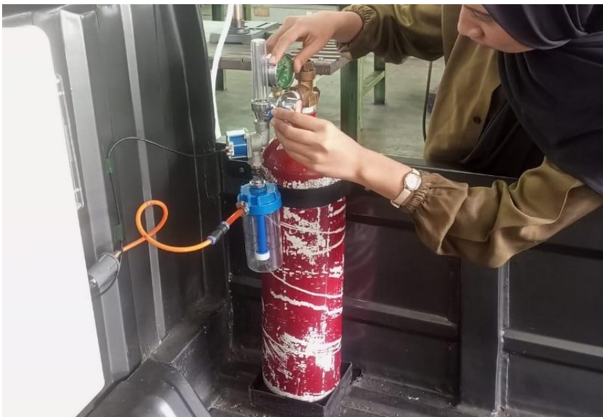
Gambar 5. 4 Konfigurasi Sistem Hidrogen ke Mobil
