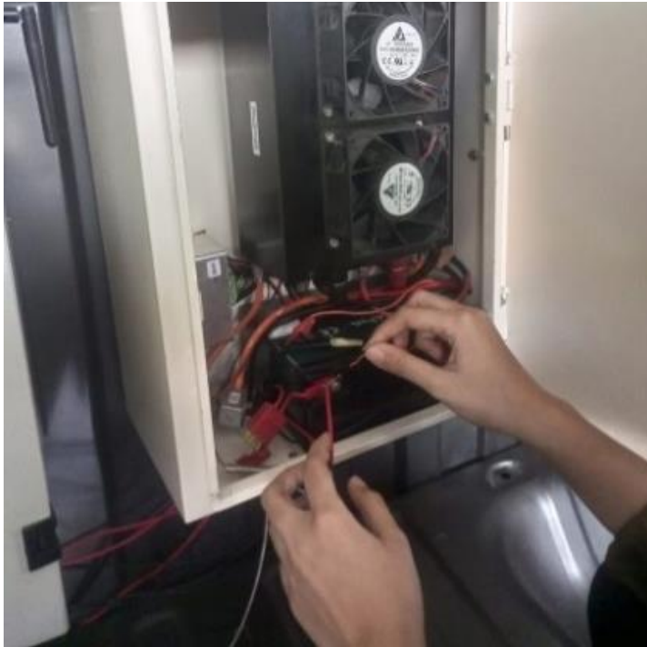
Gambar 5. 5 Perakitan PEM Fuel Cell
