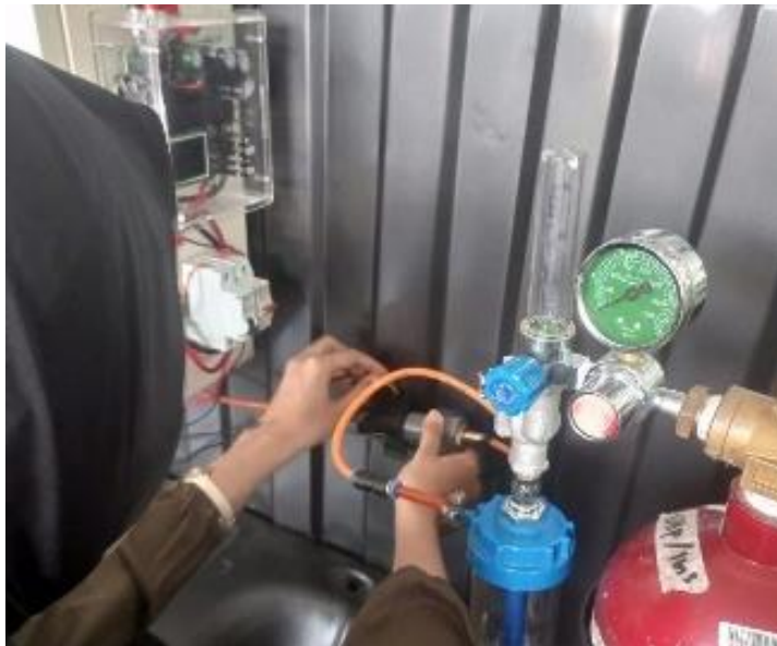
Gambar 5. 6 Konfigurasi Sistem Hidrogen ke PEM Fuel Cell
