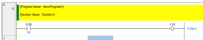
Gambar 1.18 Penulisan Alamat I/O
